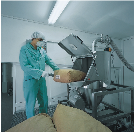
Bild 1: Sackentleerstation mit Anschluss an eine zentrale Absaugung (Bild: AZO GmbH + Co. KG)
