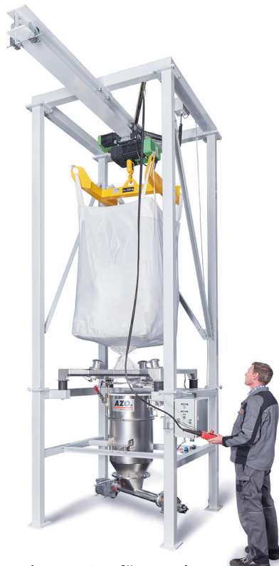
Bild 4: Entleerstation für FIBC's (Bild: AZO GmbH + Co. KG)
