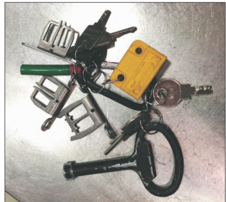
Abbildung 4: "Schlüsselsatz, der häufig für das missbräuchlichen Öffnen von Sicherheitsverriegelungen mit niedriger Kodierungsstufe verwendet wird"
